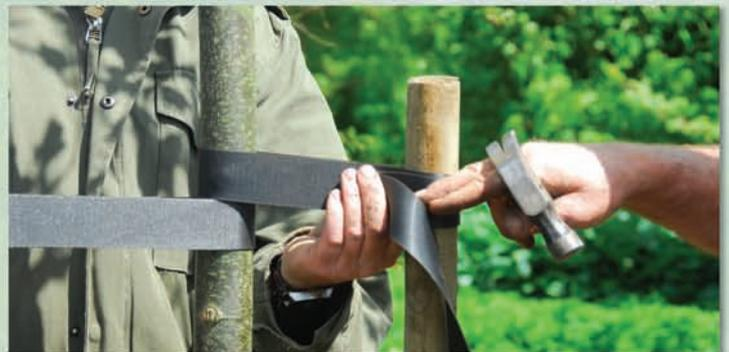
**6** Schlingen Sie die Befestigung zuerst um den Baum und fixieren Sie sie dann auf Spannung an dem Baumpfahl.
