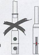
Behälter mit einer oder mehreren solcher Problemstellen sollten Sie unbedingt austauschen lassen, da der sichere Betrieb der Anlage nicht dauerhaft gewährleistet werden kann.
